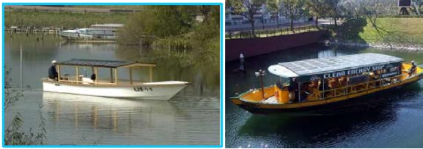
図4) 左：ソーラー和船「ソーラー秀次（ひでつぐ）丸」滋賀県近江八幡市 2006/11/3 右：ハウステンボスカナルクルーズ用電気推進船舶/基本設計は長崎総合科学大学中尾浩一氏 2010/3/16
